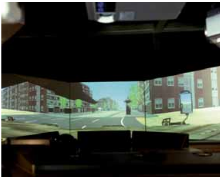
El simulador del carro Leopardo 2E permite el entrenamiento en cualquier entorno de todos los miembros de la tripulación.
