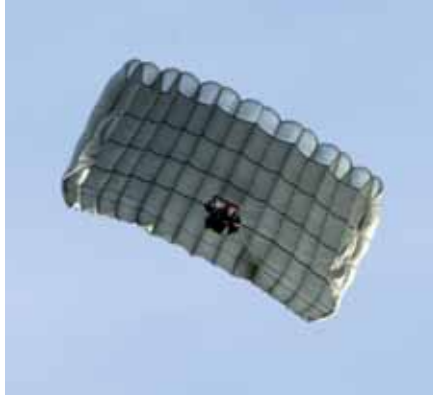
La campana en forma de ala permite realizar navegaciones muy prolongadas.
