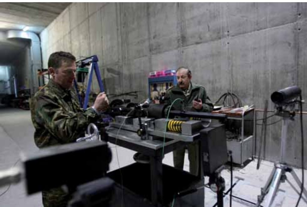
En la galería de tiro de 200 metros de longitud tienen lugar las pruebas de armas ligeras en condiciones extremas.
