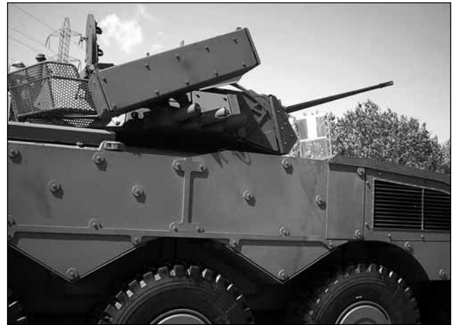
En la exposición Eurosatory 2008 fue presentada la última versión de la torre «Freccia» con dos lanzadores laterales de misiles «Spike».
