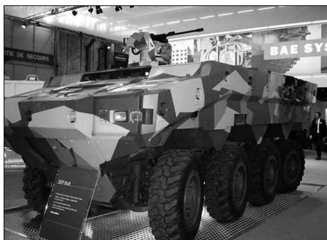
«Thor» presentado en Eurosatory 2008 en el que se aprecian los huecos dejados por dos módulos de la protección activa, tras su funcionamiento.
