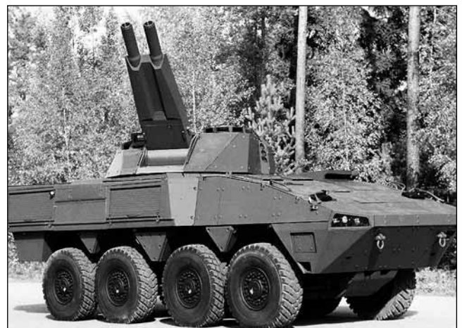
Porta-morteros de la familia «AMV» con sistema bitubo «AMOS» de altas prestaciones.
