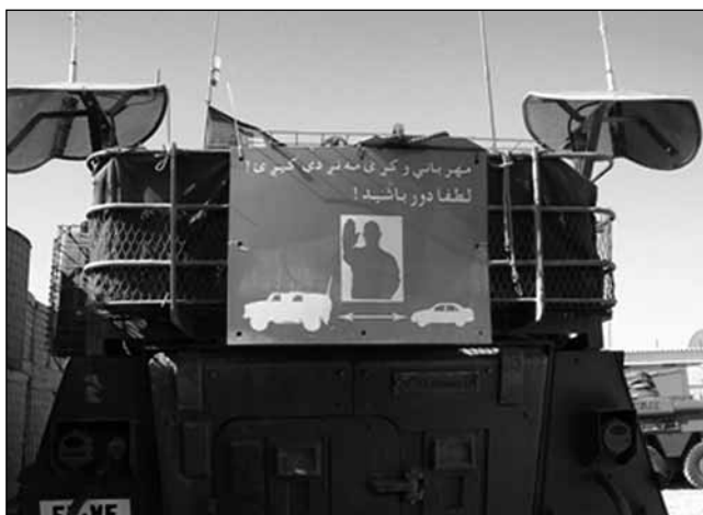
Detalle de los inhibidores en un BMR en Afganistán. Tras la cesta, cartel advirtiendo al los conductores que mantengan la distancia de seguridad (Foto del autor).
