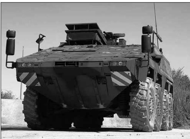
Versión básica de transporte de personal del «Boxer» dotada de una estación de armas con control remoto.
