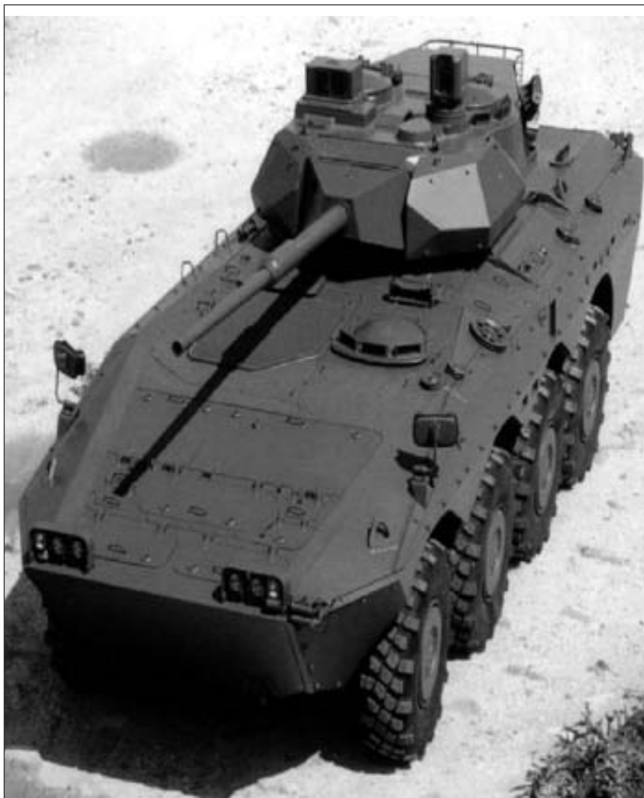
Versión de la familia "Centauro" armada con un cañón automático de alta velocidad de 60 mm
