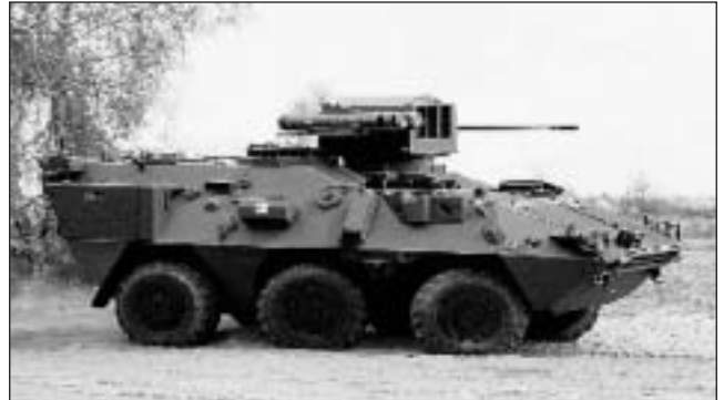
"Pandur II" con torre modular ATM dotada, en este caso, con 2 lanzamisiles HOT y un cañón de 25 mm.
