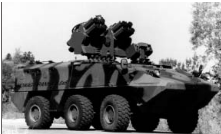
“Piraña III” 6x6 de defensa AA con el sistema de misiles británico “Starstreak”.
