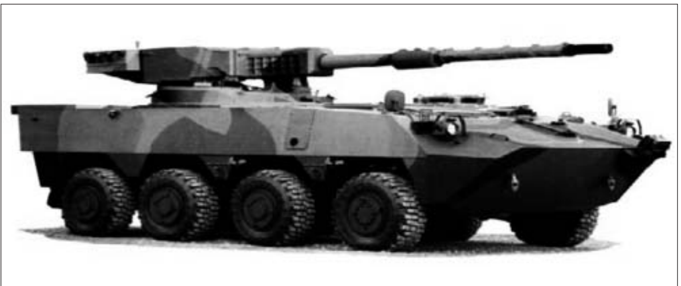
Versión 8x8 con torre de bajo perfil LPT armada con un cañón de 105 mm.
