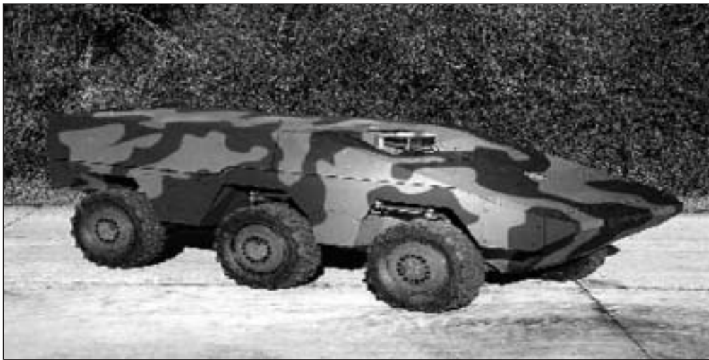
Demostrador 6 x 6 construido en 1998 para comprobar la viabilidad del proyecto "GTK/MRAV/VBCI".
