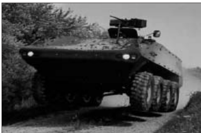
Durante el año 2001 se terminó el primer prototipo de «Pirana Generación IV» de configuración 8x8 que, con un peso en combate de 25 toneladas, puede ser propulsado por un motor Caterpillar de 522 cv o MTU de 544 cv.
