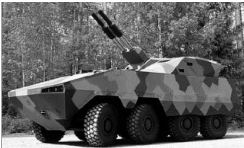
"AMV" con el sistema "AMOS" que dispone de dos morteros de 120 mm.
