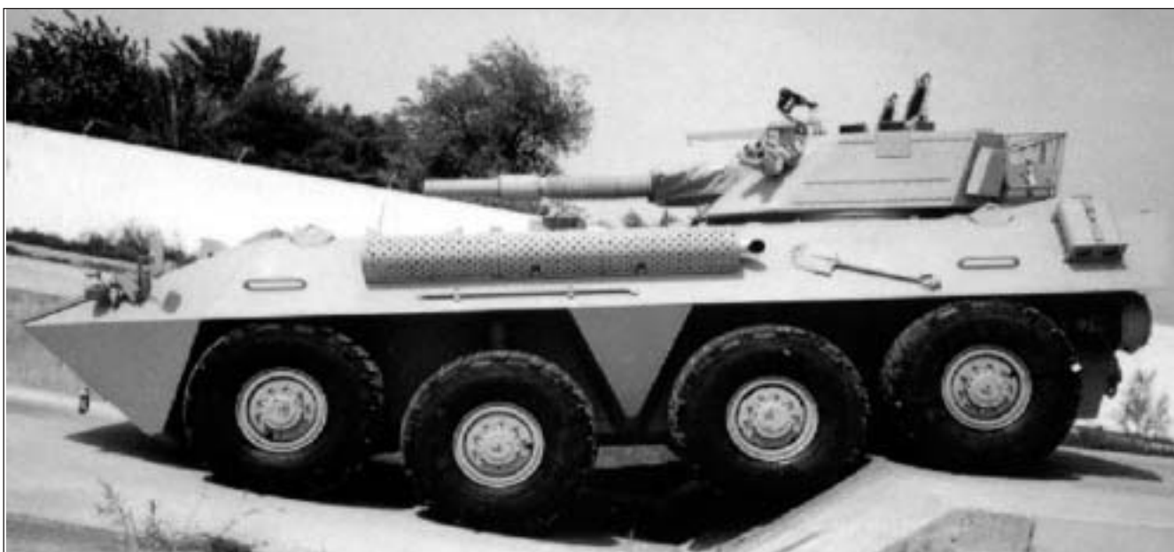
"Al Fahad" en configuración de porta-mortero de 120 mm demostrando su excelente capacidad para cruzar zanjas.
