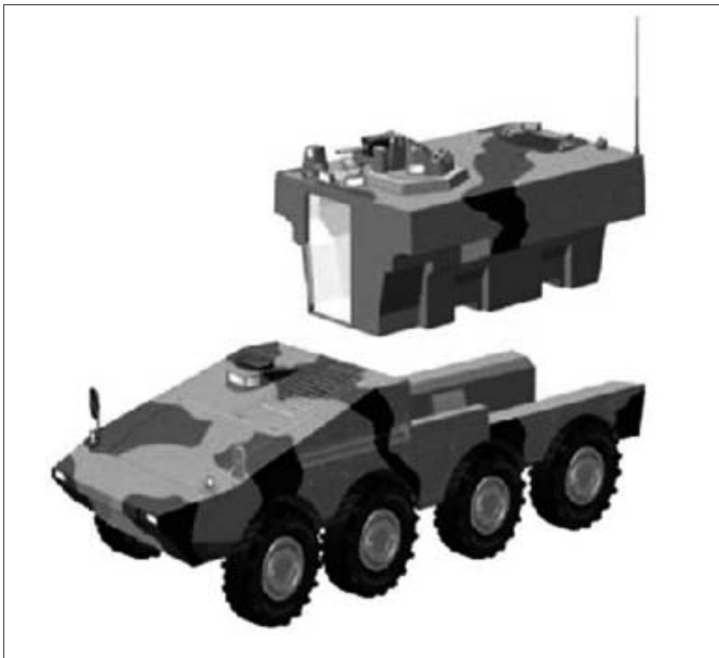
El denominado módulo de misión del "GTK/MRAV/PWV" se podrá sustituir en tan solo una hora.
