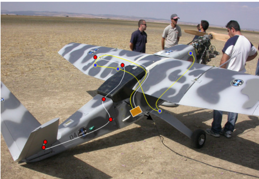
Fig. 6. SIVA instrumentado con un sistema de supervisión de cargas en vuelo basados en unos 20 sensores de fibra óptica.
