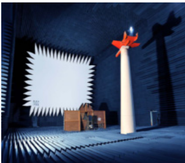
Fig. 2. Medidas de firma radar de un UAV en INTA-Torrejón.
