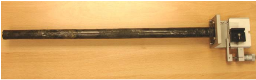
Fig. 3. Dispositivo diseñado en el INTA para realizar ensayos con las fibras libres.
