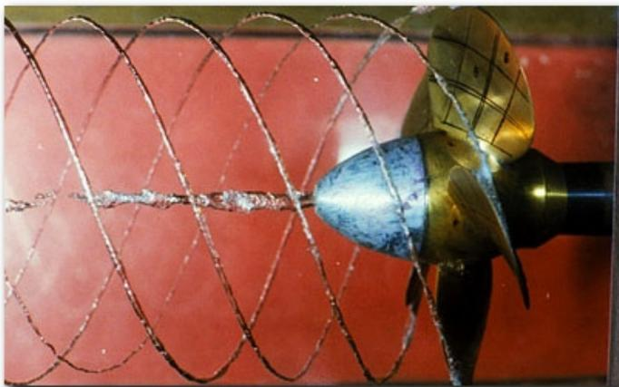
Fig. 4. Ensayo en túnel de cavitación.
