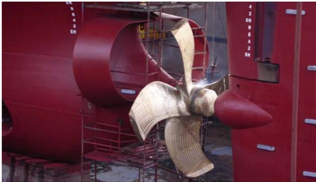
Fig. 7. Hélice CLT en el petrolero "Roy Maersk".
