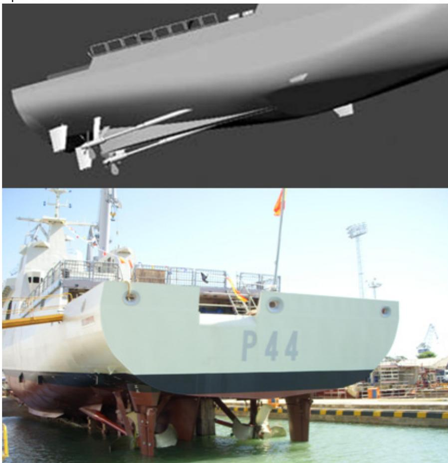
Fig. 6. Esquema y hélices CLT montadas en el BAM P44 "Tornado".
