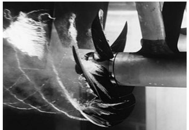
Fig. 3. Fenómeno de cavitación y ensayo en túnel de una hélice convencional.
