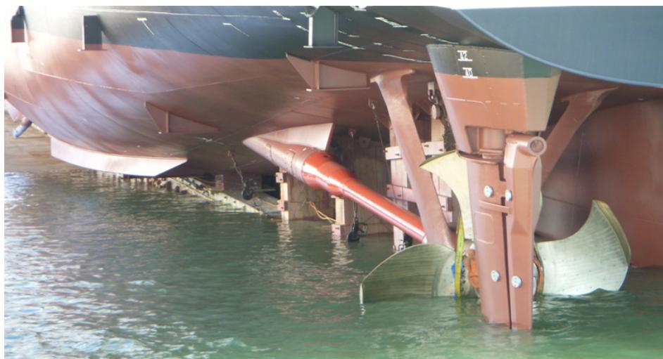
Fig. 9. Ensayo de cavitación y CLT instalada en el BAM.
