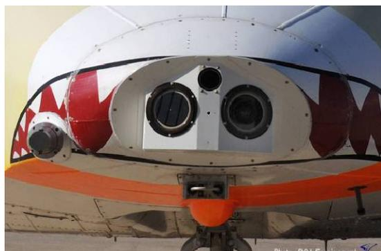
Fig. 1. Equipamiento de sensores exteriores en el morro del C-212.
