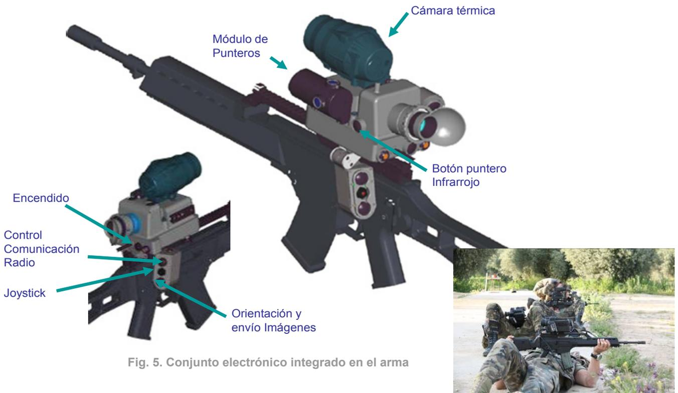
Fig. 5. Conjunto electrónico integrado en el arma
