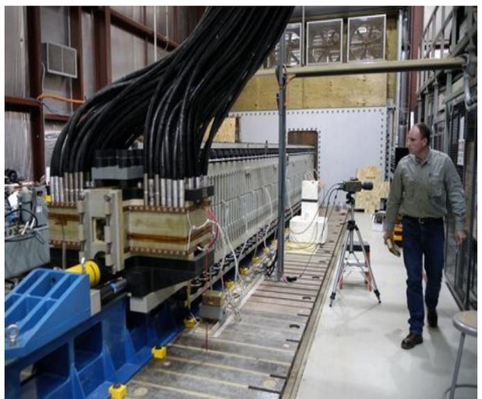
Fig. 8. Cañón electromagnético en Dahlgren (EEUU).
