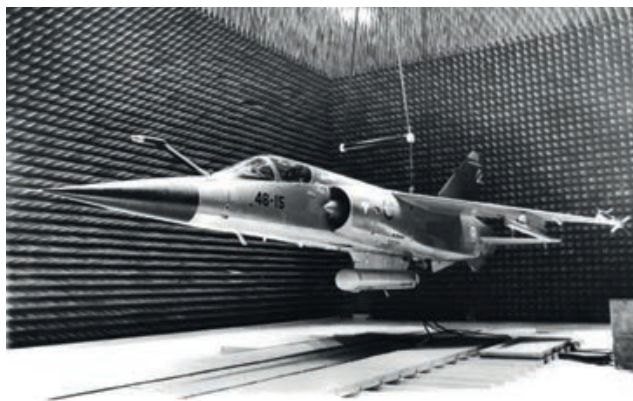
El C.14-66 en la cámara anecoica del C.E.V. de Istres durante la integración de los equipos de GEL
