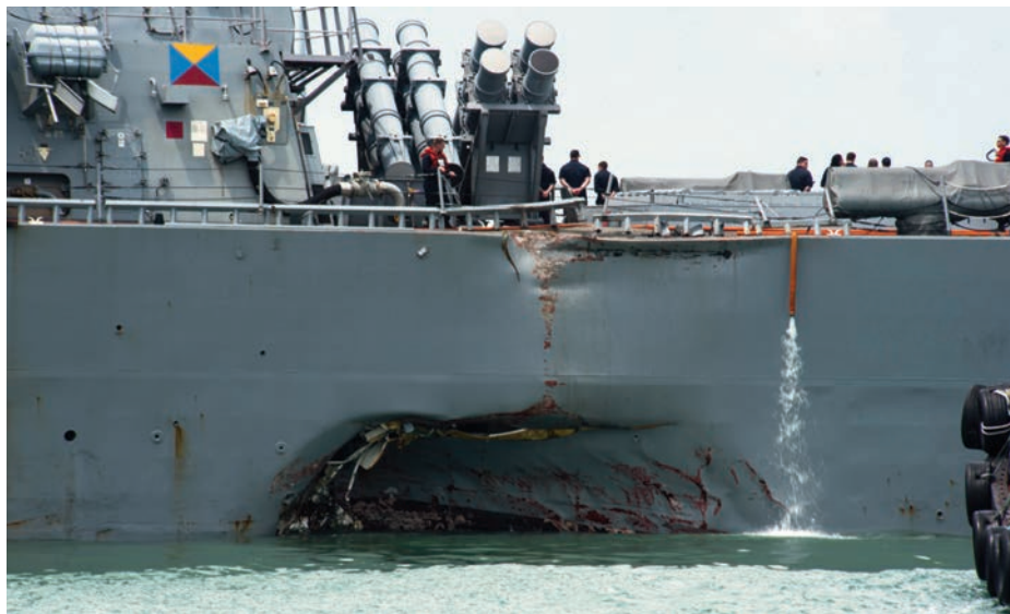
Daños sufridos por el destructor John S. McCain . (Foto: www.wikipedia.org ).
