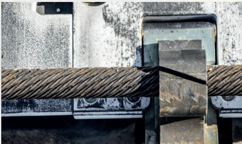
Cable de frenado listo para la prueba
