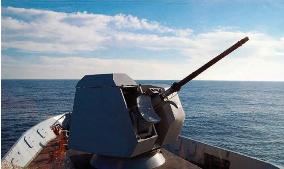
Montaje Oto Melara de 76 mm con el sistema STRALES. Nótese la pequeña antena para guiar la munición. (Fuente: Leonardo)
