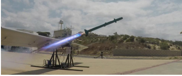
Separación segura en pruebas S/S en CEDEA. (Fuente: propia)
