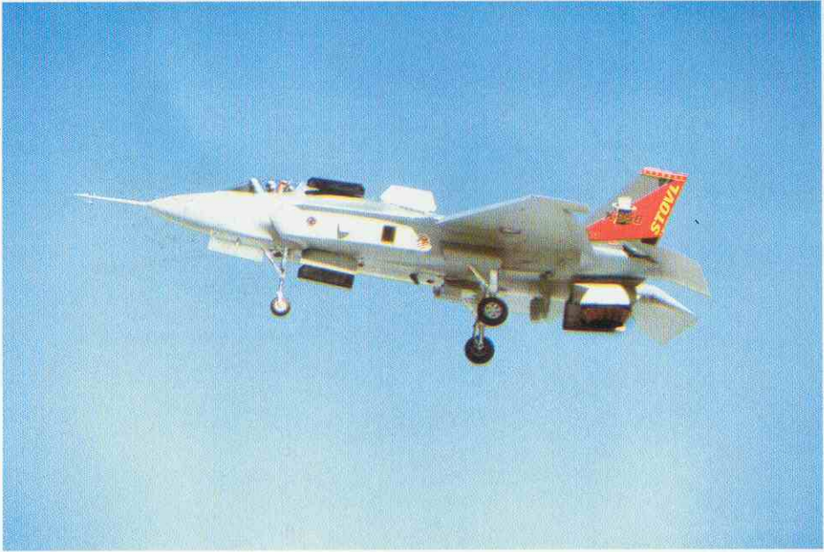
X-35B (STOVL). Despegue corto y aterrizaje vertical.
