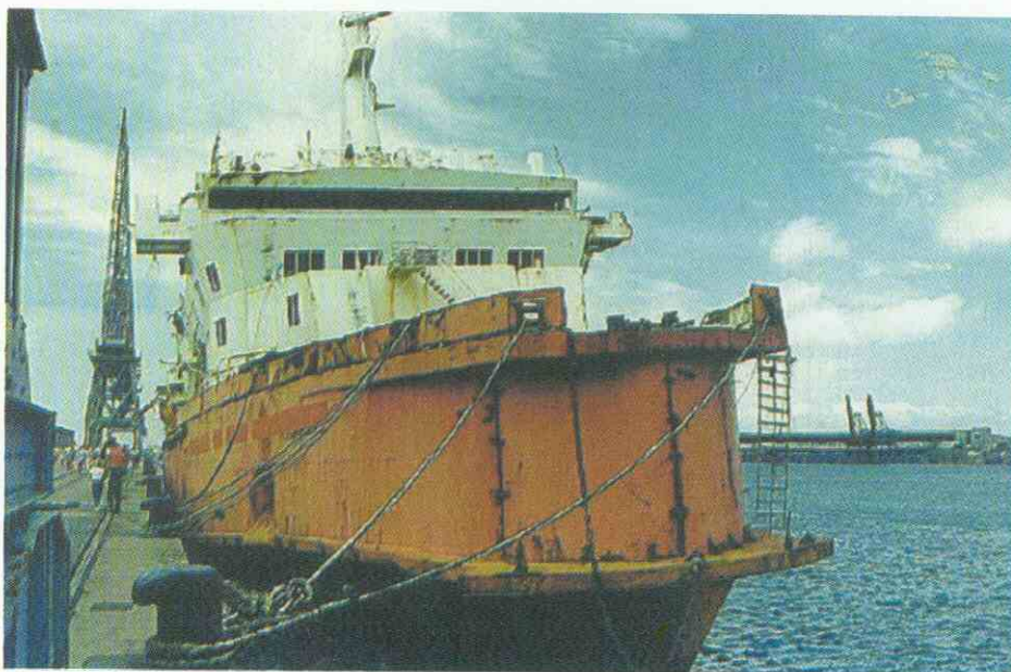
Camino del desguace. Fotografía obtenida con toda probabilidad durante una arribada a Port Elizabeth (R.S.A.) en ruta hacia Taiwan. Obsérvense los accesos de vehículos a las cubiertas E y G, esta última con la puerta ya cerrada y soldada. El calado a proa es anormalmente escaso.
