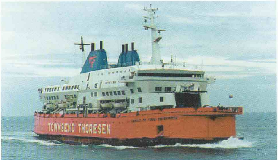
El Herald of Free Enterprise navegando normalmente. Obsérvese la ola de proa, algo menos de un metro, bajo la puerta de la cubierta G.
