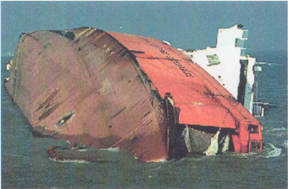
El Herald zozobrado. Obsérvese que los estabilizadores aún no han sido desplegados y que la puerta de proa está abierta y cubierta por una lona, colocada probablemente para evitar la dispersión de los cadáveres.
