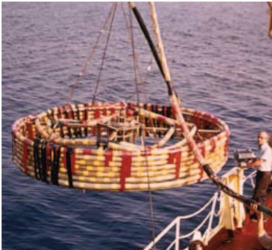
Calibrado del TAS de la US Office of Naval Research en 1978. (Fuente: Thirty_years_of_towed_arrays_at_NURC )
