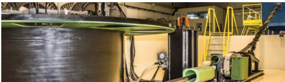
SOLARSUB. Sonar Remolcado Digital y sistema automático de despliegue y recogida. (Fuente: https://electronica-submarina.es/wp-content/uploads/2018/04/sonar_solarsub-1.jpg )
