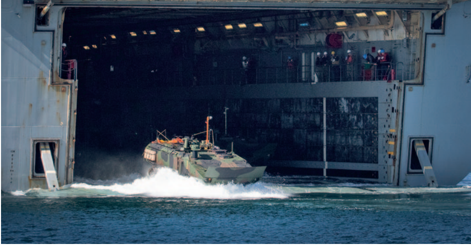
Un ACV-P sale del dique de un buque anfibio norteamericano. (Fuente BAE Systems)
