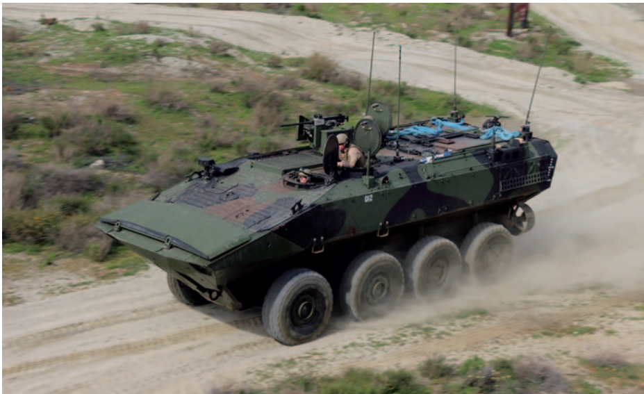
ACV-P efectuando pruebas de movilidad en tierra. (Fuente: USMC)
