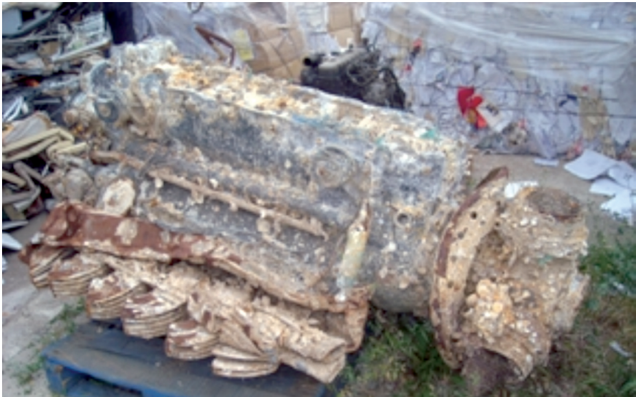
Vista frontal del motor Jumo 211F. La observación de los restos permitía comprobar que la tapa del cárter del cigüeñal había desaparecido y estaba equipado con una hélice tripala de madera. (Foto: José Miguel Sales Lluch).
