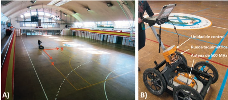
Figura 4. A) Zona a prospectar, y B) Equipo georadar utilizado y componentes: unidad de control, antena apantallada de 500 MHz (emisor y receptor), portátil y rueda taquimétrica (odómetro).
