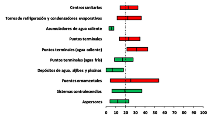
Figura 5. Prevalencias medias e intervalos de confianza 95 % (%) de Legionella según tipo de instalación (valores medios altos en rojo y bajos en verde)
