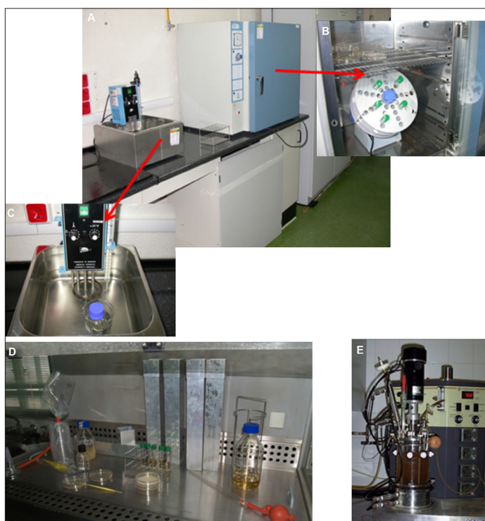
Figura 3. A. Estufa de cultivo y Baño termostatzado. B Detalle interior de la estufa. C. Detalle interior del Baño. D. Cabina de Seguridad Biológica. E. Fermentador.
