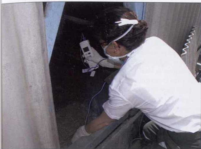
Fig. 2. Medición de temperatura y nivel de biocida.
