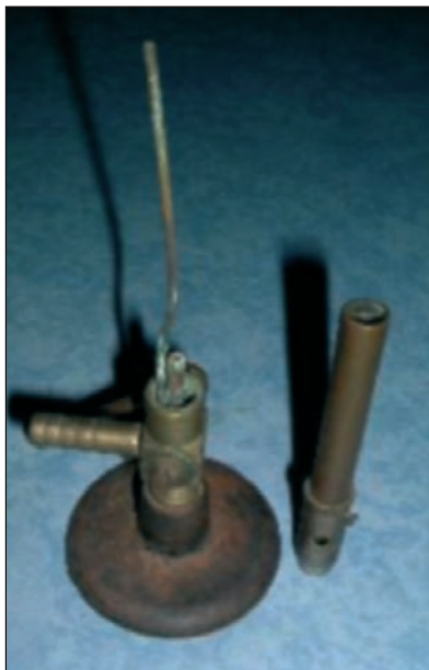
Figura 5. Varilla del interior del tubo para impedir que el mechero se cale.
