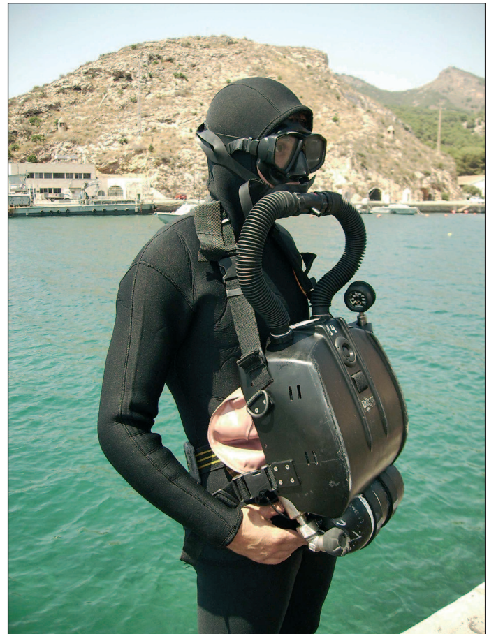
Figura 1: Equipo de circuito cerrado LAR VI que se utilizó en el estudio.
