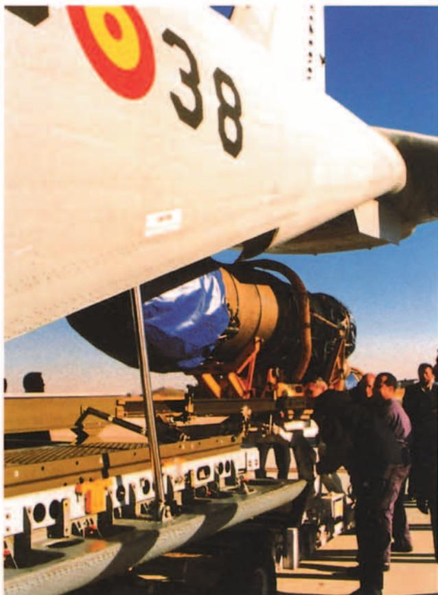
Para incrementar la capacidad de la Aviación de Transporte, en el Ejército del Aire, MAESMA ha desarrollado y construido dos cunas de transporte de motor que permiten al avión T19 poder transportar uno o dos motores a la vez.
