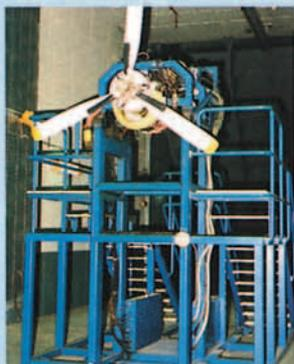
a) Celda nº 1: pruebas con hélices de motores de hasta 2.000 ESHP (actualmente se prueban los motores Garrett TPE 331-2, -5, -10 del avión T.12/TM.12/D.3 Aviocar en sus diferentes versiones).
