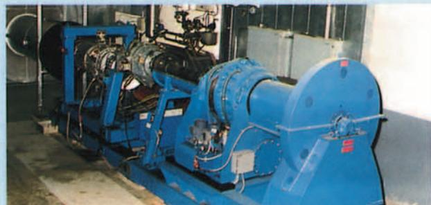
Bancada de prueba con freno de agua de motores Allison T.56.
