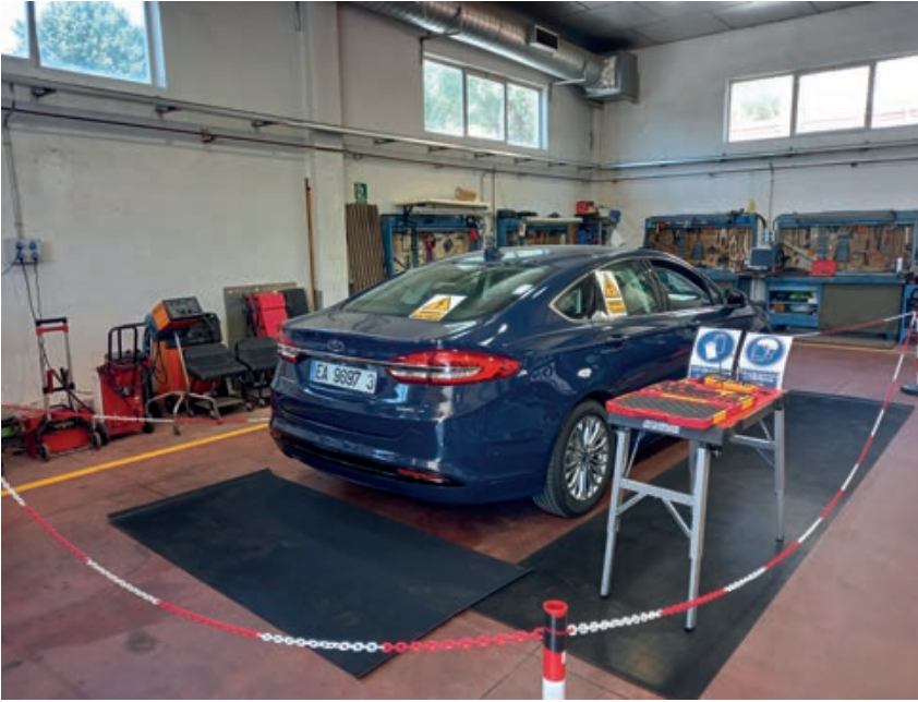
Puesto de trabajo específico vehículos híbridos o eléctricos. (Imagen: CLOMA)
