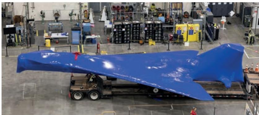
El avión X-59 QueSST de la NASA es fotografiado en las instalaciones de Lockheed Martin Skunk Works en California, preparado para su traslado a Texas. El avión X-59 se someterá a pruebas en tierra para garantizar que pueda soportar las tensiones del vuelo antes de regresar a California para su finalización. (Imagen: Lockheed Martin)
