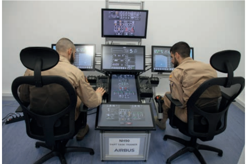
El Ala 48 ya cuenta con un sistema PTT, de gran utilidad para la transformación de los futuros pilotos del NH90
