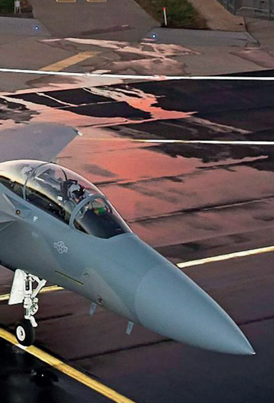
Imagen de Boeing del F-15SA en la que se aprecian, entre otros detalles, la activación de las estaciones de armamento 1 y 9 y la nueva motorización. (Imagen: Boeing)
