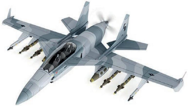
*El SM-27T Machete, dotado de un turbo propulsor Pratt & Whitney Canada PW150, con dos hélices contrarrotatorias. (Imagen Stavatti Aerospace)*
