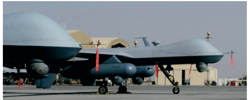
El pod Gorgon Stare, bajo el Reaper, identifica y reconoce objetos visualizados previamente.
