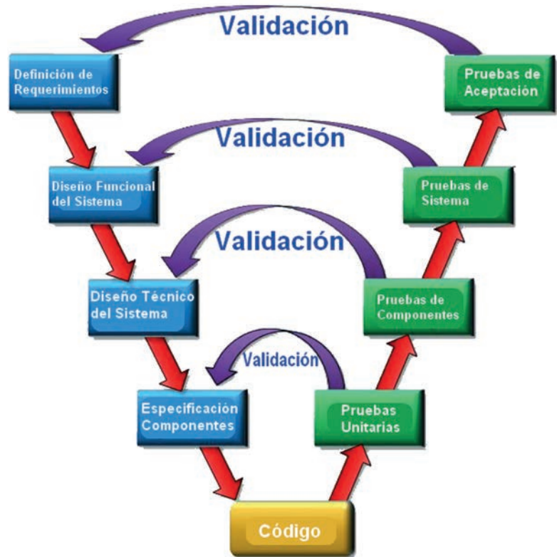
Modelo en V. Especificación de requisitos de un OFP (Operational Flight Program).
