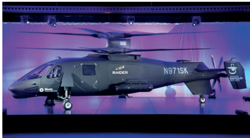
Sikorsky con doble rotor coaxial contrarrotatorio y hélice propulsora en la cola.
