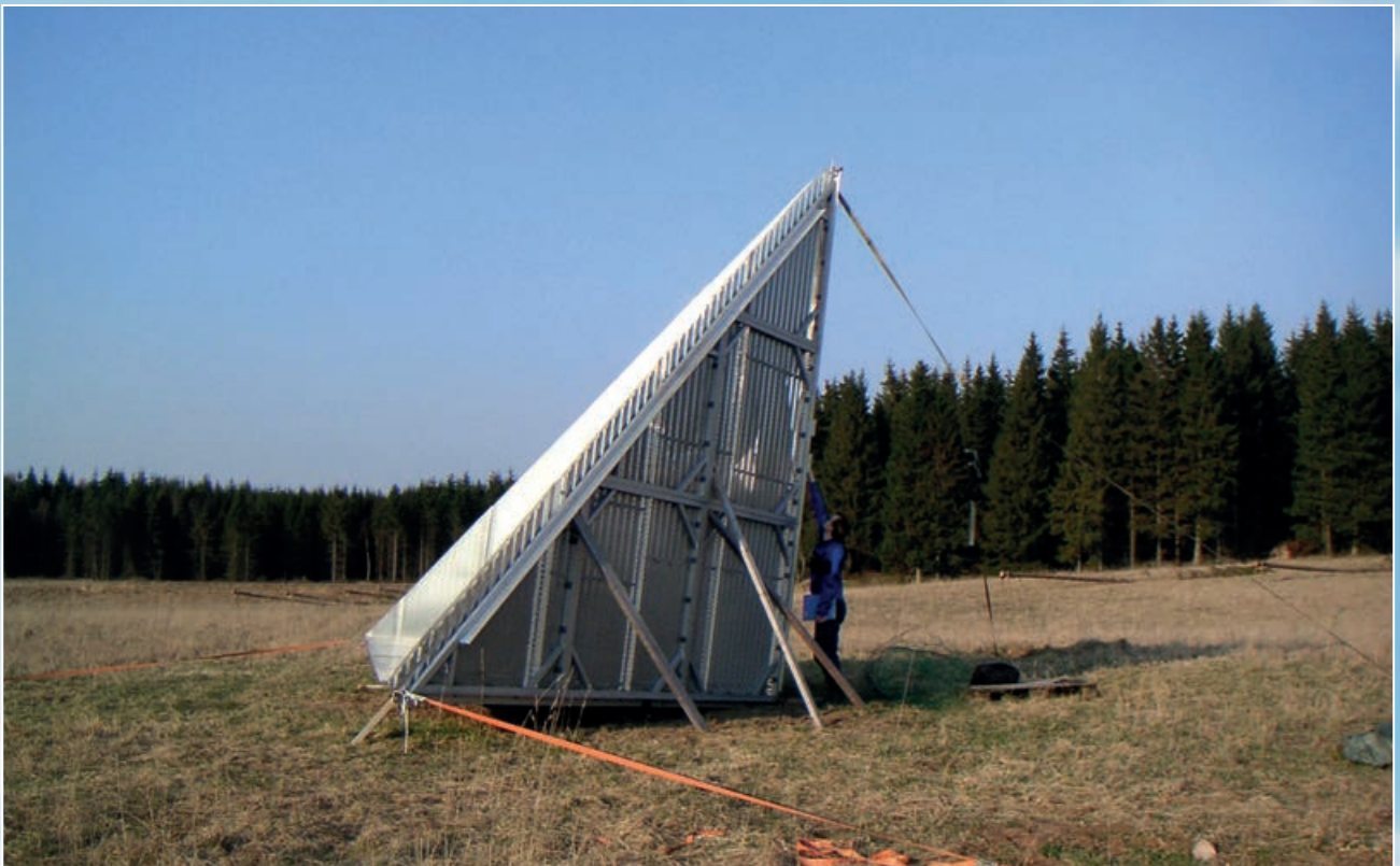
Uno de los reflectores con forma de esquina utilizados durante la campaña de ensayos BioSAR. (Foto: ESA)
