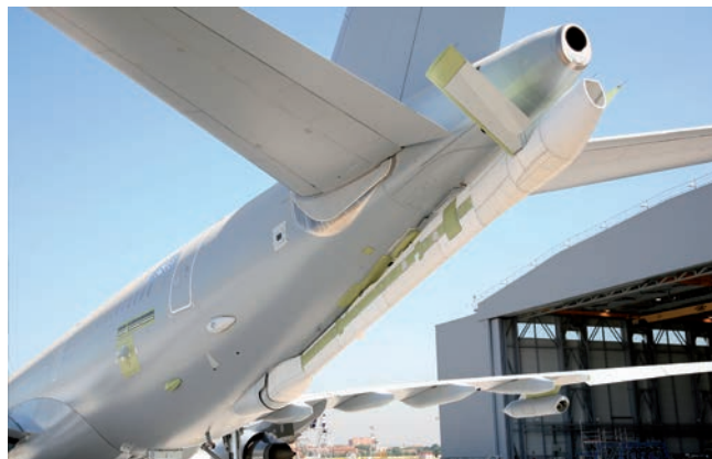
Detalle de la percha ARBS (Aerial Refuelling Boom System) que equipa alternativamente a los MRTT, un diseño de Airbus DS para reabastecer a aeronaves equipadas con receptáculo. Foto: Airbus.
