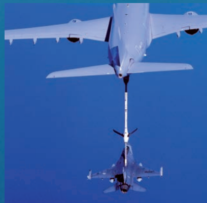
Detalle de cómo reposta el MRTT con la percha a un aparato dotado de sistema de receptáculo, como es este F-16 de Portugal. Foto: Airbus.
