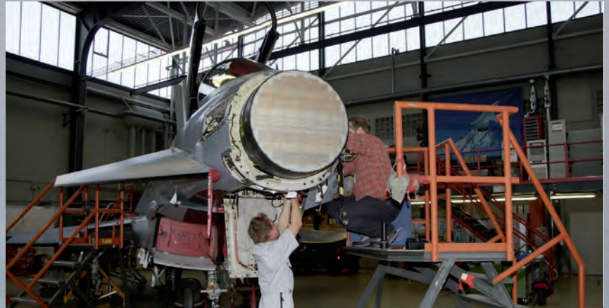
Un radar Captor-E prototipo ha sido instalado en el avión instrumentado de serie IPA 5 previamente modificado para realizar las pruebas en vuelo.
