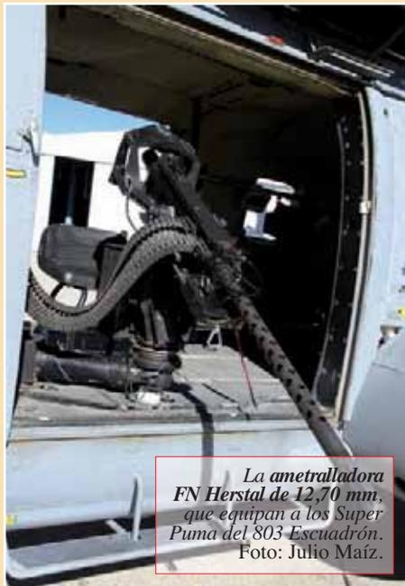
*La ametralladora FN Herstal de 12,70 mm, que equipan a los Super Puma del 803 Escuadrón.*
