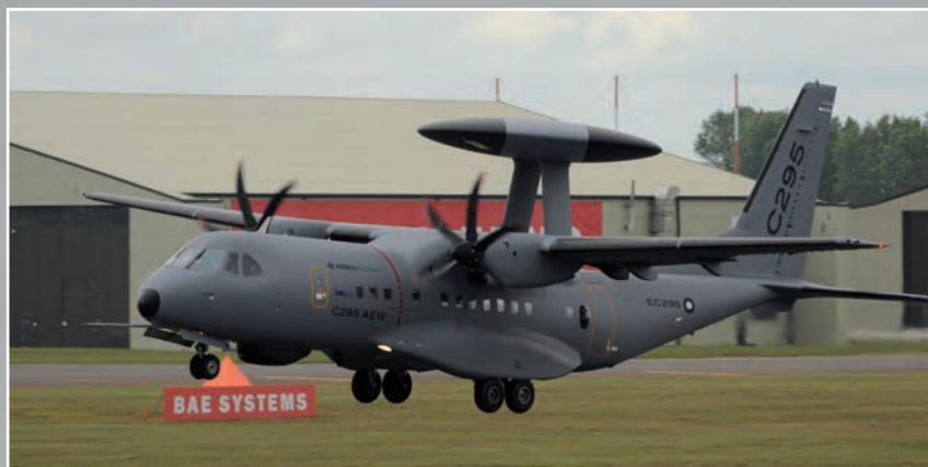
Despegue del C295 AEW&C a los mandos del piloto de ensayos Carlos Pinilla. Airbus Military e Israel Aerospace Industries (IAI) se han unido para desarrollar una plataforma de control y alerta aerotrasportada basada en el C295 y en el radar IAI/ELTA de cuarta generación AESA (Active Electronically Scanned Array).
