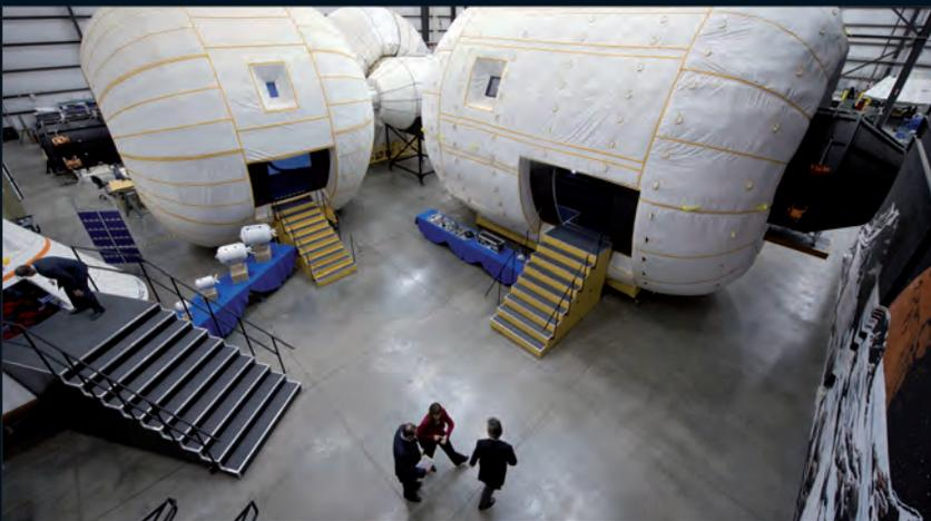
Los módulos inflables, como los de la empresa Bigelow Aerospace, serán la solución ideal para el NAUTILUS-X. (Foto: Bigelow A.)
