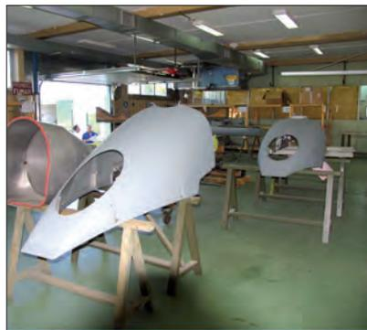
*Carenados de la zona de salida de gases de escape de un avión, listos para revisar/repairar.*
