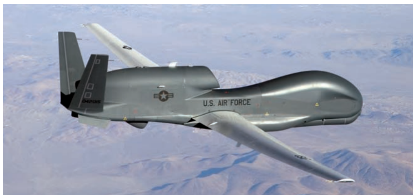
El Euro Hawk es un Global Hawk del bloque 20, modificado para poder llevar como carga de pago un sistema de inteligencia de señales integrado
