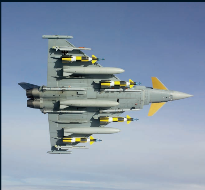
IPA 3 (RU) EN CONFIGURACIÓN MIXTA. Continúa a buen ritmo el programa de ensayos en vuelo para garantizar las nuevas capacidades operativas tanto de los aviones de Tranche 1 como de Tranche 2. En la foto, el avión de producción instrumentado (IPA-3), asignado al programa de ensayos en vuelo, efectúa una prueba con una configuración mixta aire-aire y aire-suelo como parte de la calificación de las nuevas capacidades operativas.
