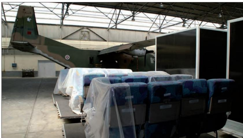
C-212 equipados con paneles dotados de butacas para realizar misiones de transporte VIP.
