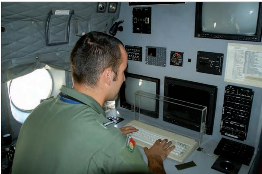
Detalle del panel de control de los sensores del C-212-300 de las FAP.
