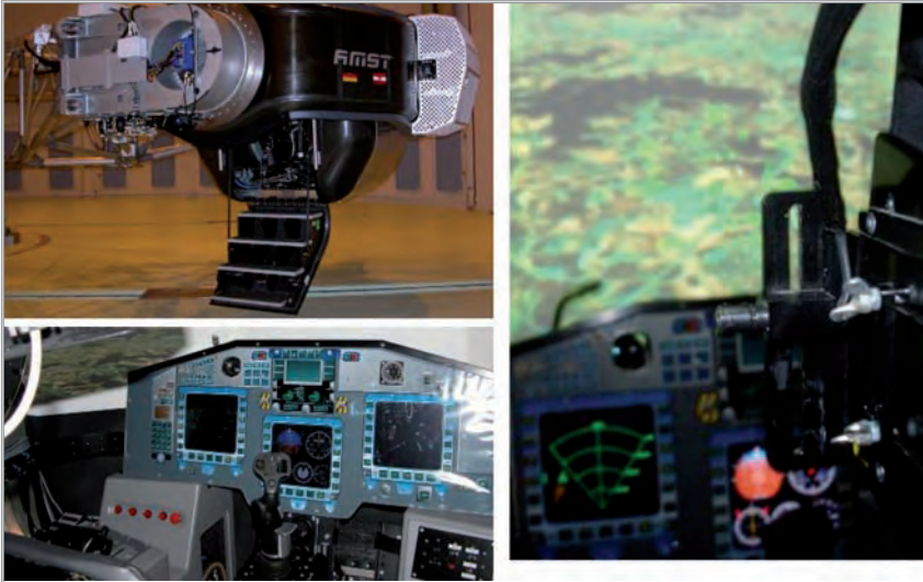
Figura 3. La góndola de la centrífuga reproduce la cabina del EF-2000 con un campo de visión de 120 x 40° con pantallas HUD y HDD con control activo por el piloto.
