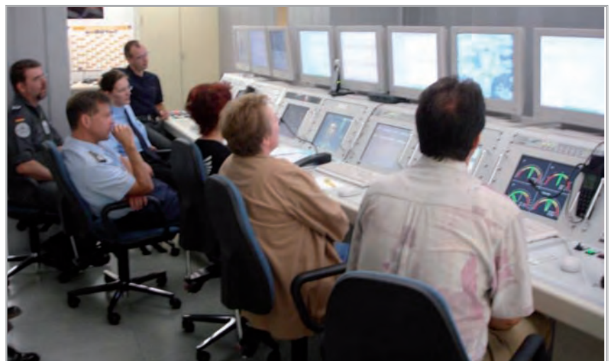
Figura 4. La sala de operaciones de la centrífuga dispone de múltiples pantallas que permiten visualizar y comunicarse con el piloto alumno y donde se registran diferentes parámetros fisiológicos, del entrenamiento y de los equipos mecánicos de la centrífuga. Los datos son grabados. Estas funciones precisan la presencia de al menos siete técnicos bajo la dirección del oficial médico aeronáutico.
