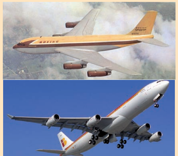
Figura 3. Los aviones Boeing B707 (arriba) y Airbus A340 (debajo) han sido diseñados con 40 años de diferencia, pero ambos responden a la misma configuración.
