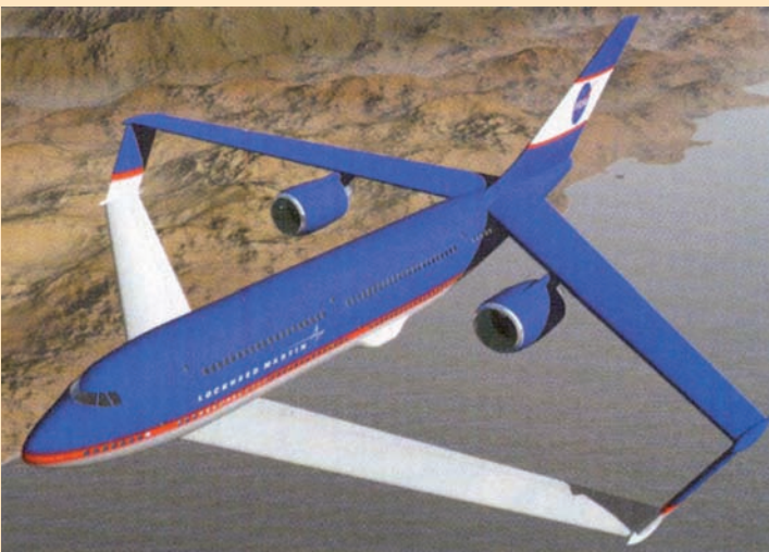
Figure 5. Avión en configuración de biplano de Prandtl ("joined wings").
