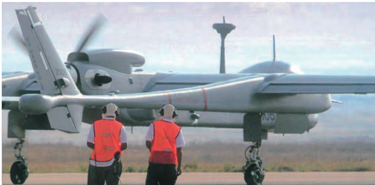
El SDM sería un avión de tipo MALE preparado para volar entre 6.000 y 10.000 metros de altura con una autonomía de unas treinta horas.
