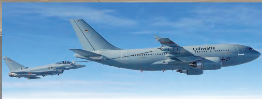
A finales de octubre empezaron las pruebas en vuelo para la certificación de reabastecimiento en vuelo desde el cisterna Airbus A310 MRTT del Eurofighter.
