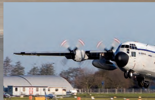
El 17 de diciembre tuvo lugar el primer vuelo de pruebas en vuelo (Flight Test Bed) con un motor TP400,
