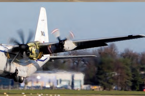
El avión C-130K utilizado como plataforma de prueba para la futura planta de potencia del A400M.
