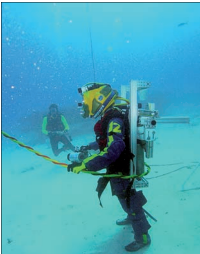
El traje utilizado permite modificar su centro de gravedad. (Foto: NASA)
