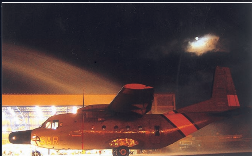
PARA EVITAR PROBLEMAS DE CORROSIÓN, LOS AVIONES SE LAVAN DESPUÉS DE CADA SALIDA.
