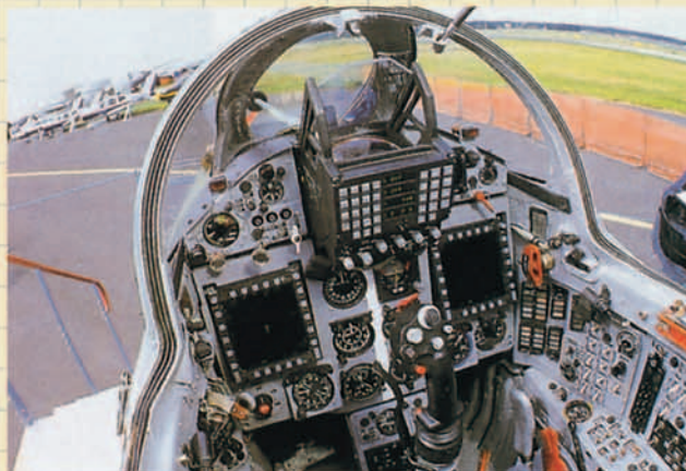
Cabina del Mig-21 Lancer de la Fuerza Aérea rumana, antes y después de la modernización de la empresa israelí Elbit.
