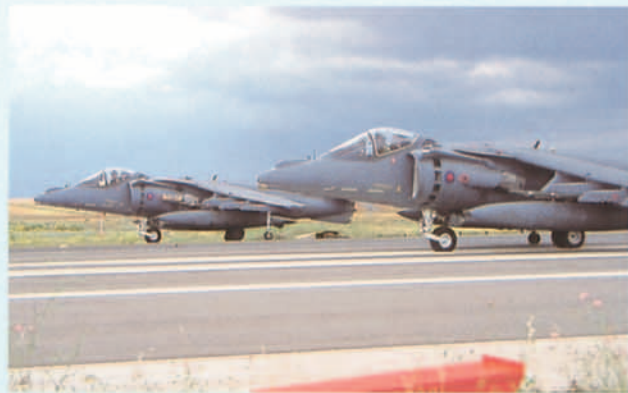
Llamó la atención, sobre todo, la espectacular aproximación del Harrier reduciendo velocidad hasta que efectuaba el contacto con la pista, casi como un helicóptero, gracias a la posibilidad de deflexión de sus toberas que le proporcionan empuje vectorial.
