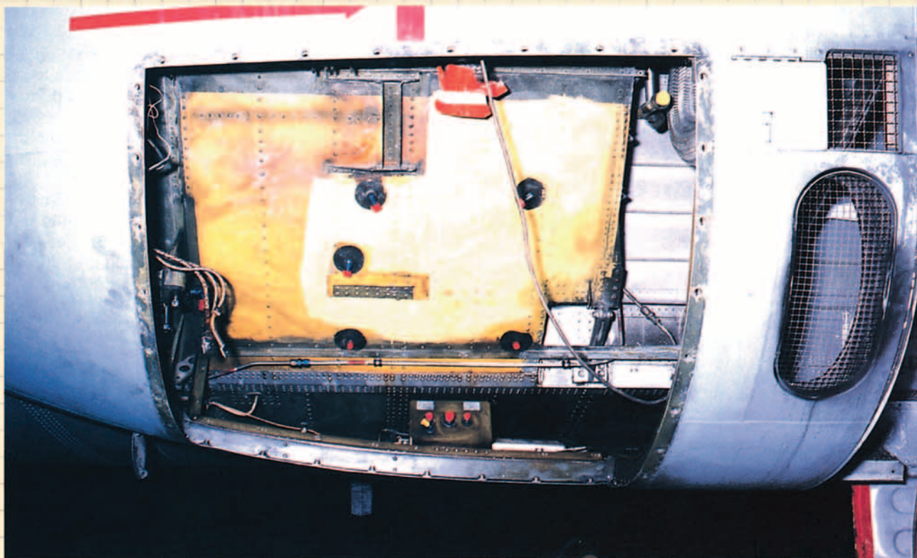
Los GTC/ATM serán sustituidos por los modernos APU 180LE.
